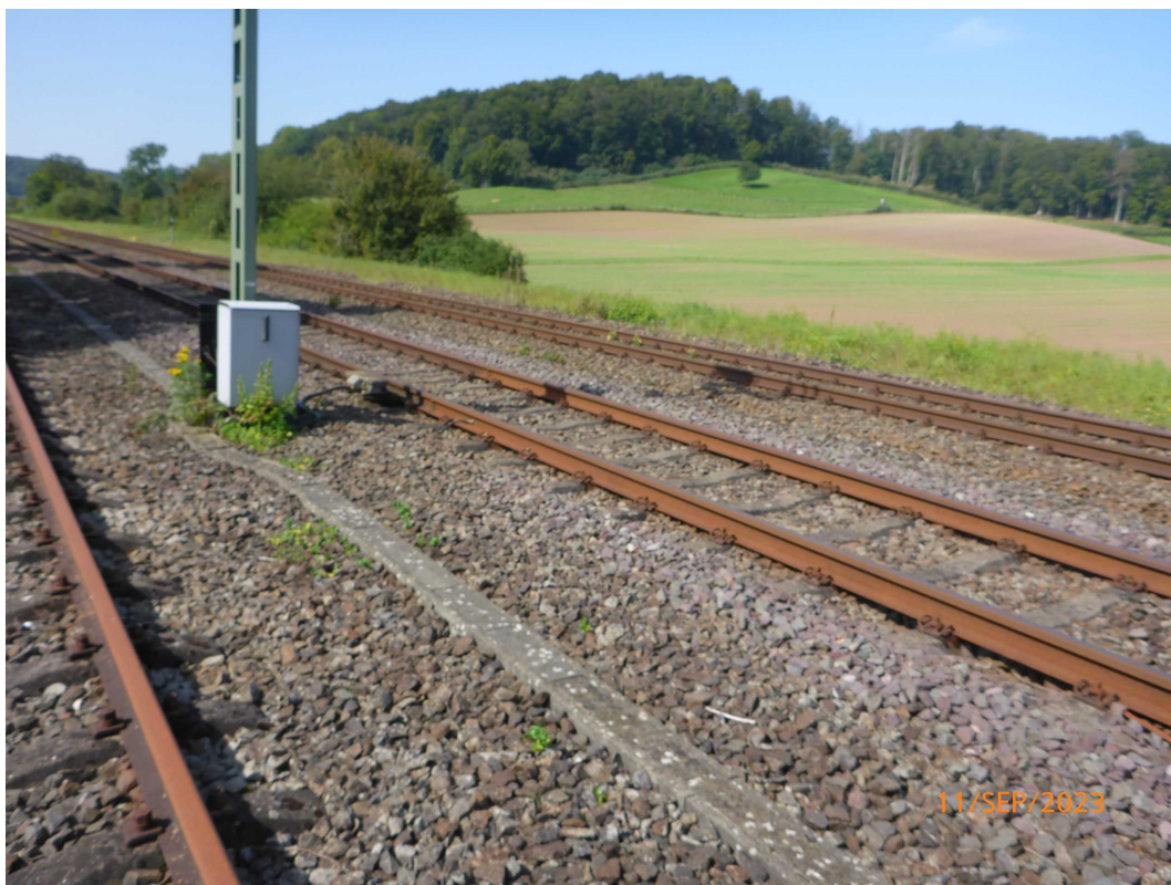
Bild 17: Achszähler, Radsensor km 14,615
